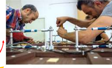
Retrait de l'ancien châssis auxiliaire par les restaurateurs support, mesures de déformations en temps réel par les kits déformométriques (juillet 2017)
