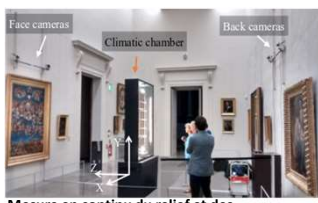
Mesure en continu du relief et des déformations du panneau par stéréovision (face et revers) par PPrime (2016 → actuellement)
