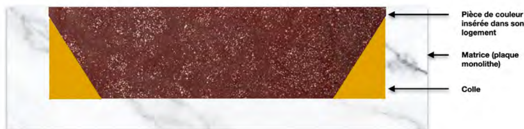
Schéma en coupe transversale d'un panneau en tarsia
