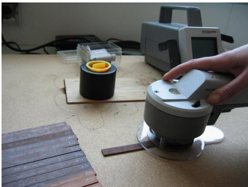
Mesure colorimétrique sur des échantillons d'Amourette (mouchetée et non mouchetée).
