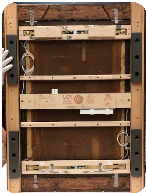
Vue arrière du système d'encadrement de La Joconde : panneau de peuplier maintenu dans un châssis-cadre en chêne au moyen de traverses en érable équipées de limiteurs de force, le tout placé dans le cadre visible de face. La traverse centrale contient entre autres l'électronique permettant la transmission en temps réel des données du monitoring.
