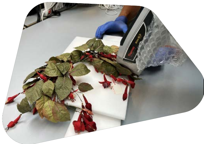
Analyse XRF d'une couronne de fleur (GAL 2004.323.X) daté vers 1860 et conservée au musée du Palais Galliera.
