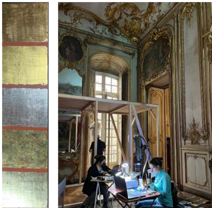
Analyses des surfaces dorées par LIBS – Projet CléOR
