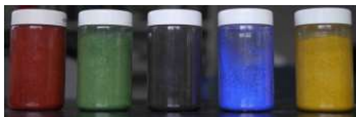
A l'état pur, de gauche à droite : oxyde rouge, vert de chrome, oxyde noir, bleu outremer, oxyde jaune.
