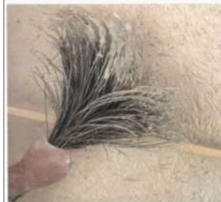
2. La pièce de bois est frappée avec le balai pour donner du relief.
