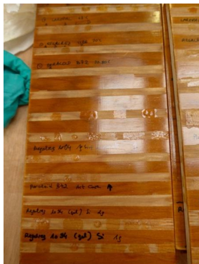
Tests de comblements de lacunes de vernis
